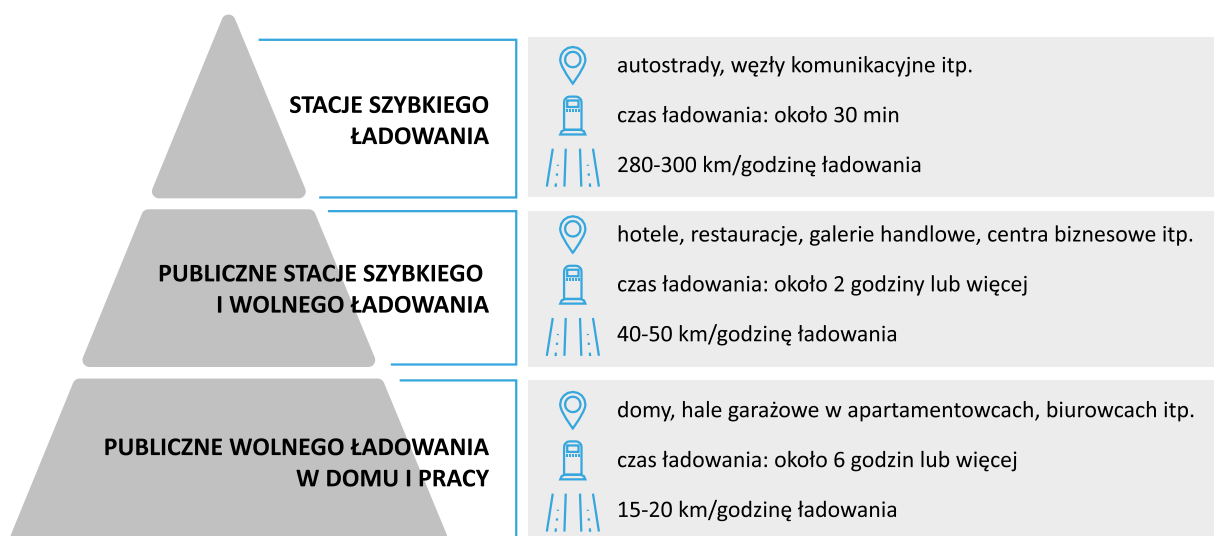
Rysunek 14: Mix infrastruktury ładowania pojazdów elektrycznych
